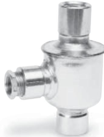
El TAVB de Armstrong es una combinación de purgador termostático de aire y válvula reductora de vacío perfectamente adecuado para recipientes llenos de vapor con controles de modulación. El TAVB purgará aire y otros gases no condensables de recipientes como intercambiadores de calor de carcasa y tubos, calderas con camisa y bobinas de vapor durante su funcionamiento. También interrumpirá el vacío que se forma durante la modulación de control del vapor.
