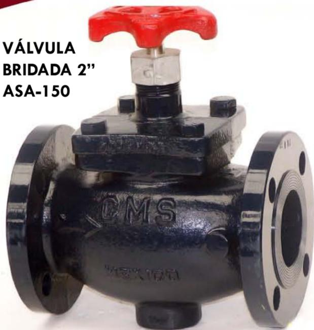
Las válvulas de globo bridadas ASA-150 y ASA-300 se usan en tuberías soldadas de baja presión tales como líneas de trasiego, en succión de bombas y en líneas de vapor en instalaciones de aprovechamiento de Gas LP y amoniaco anhidro. Están diseñadas para proporcionar un cerrado hermético en servicio continuo, para manejo de vapores o líquidos.
