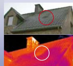
La inspección por infrarrojos localiza el punto del tejado que presenta un aislamiento deficiente. De este modo, es fácil reparar el daño y evitar pérdidas de energía.
